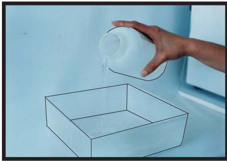
TOME EL AGENTE CURATIVO YA PREPARADO Y VIERTA UNA PORCION EN LA CHAROLA DE PLASTICO. (QUE ALCANCE UNA ALTURA DE 2 CENTIMETROS EN LA CHAROLA)
