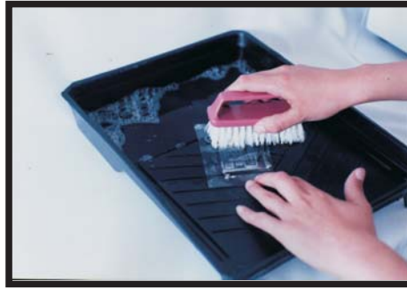
VIERTA DETERGENTE EN SU CHAROLA DE LAVADO Y TALLELO CON EL CEPILLO DE CERDAS HASTA QUE RETIRE TODO EL EXCESO DE FOTOPOLIMERO.
