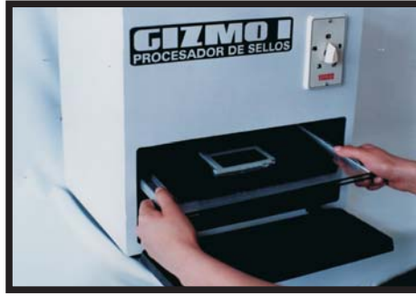
ABRALA PROCESADORA Y PONGA EN EL INTERIOR SU ENSAMBLE CON EL SUBSTRATO HACIA ARRIBA. ESTO ES PARADAR EL TIEMPO DE BASE.
