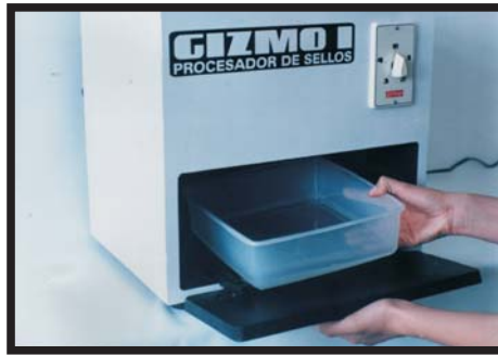
PONGA EN LA CHAROLA CON AGENTE CURATIVO LA GOMA DEL SELLO, ABRA LA PROCESADORA Y META LA CHAROLA DENTRO.
